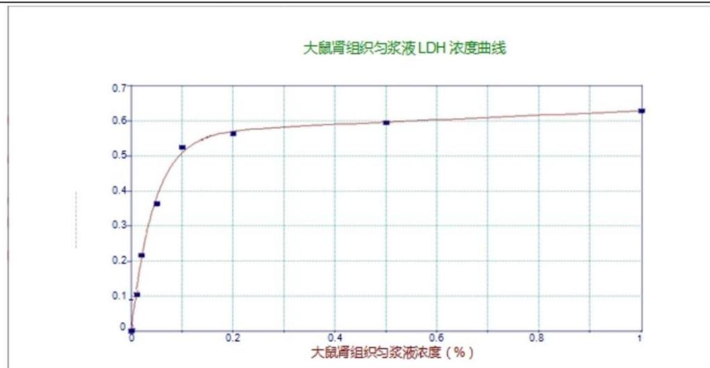
由以上曲线可见绝对吸光度 OD 值介于 0.05~0.50 之间呈线性相关，最佳绝对吸光度在控制在 0.2~0.4 之间，根据您实验中的具体情况来选择最佳取样浓度
